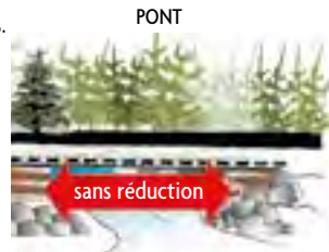
DIAMÈTRE MINIMUM DU TUYAU
