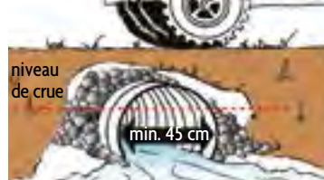
DIAMÈTRE MINIMUM DU TUYAU
