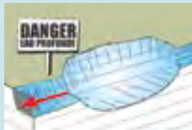
BASSIN DE SÉDIMENTATION
