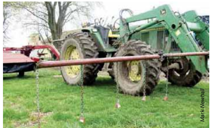
Figure 4.17 La barre d'effarouchement. Les chaînes doivent toucher au sol pour que la barre soit efficace. L'utilisation de cloches n'est pas nécessaire pour l'herpétofaune, bien qu'elle peut l'être pour d'autres espèces animales.
