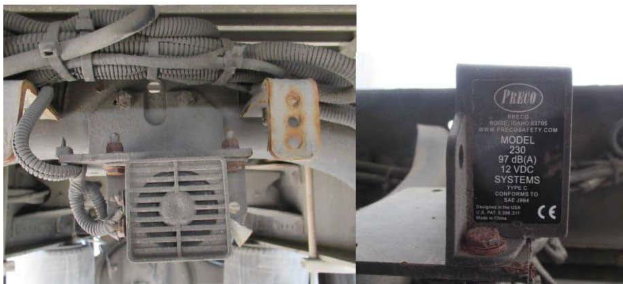
Photos 9 et 10 : Alarme de recul
