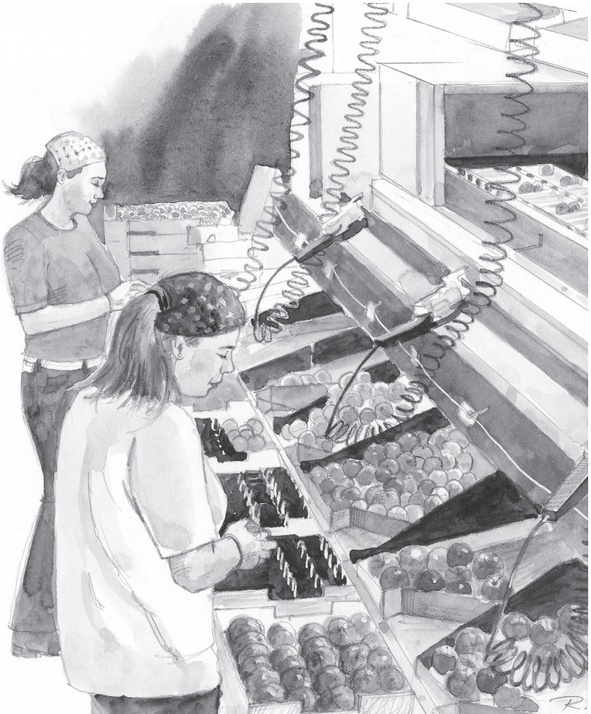
Poste de tri où s'effectue un premier triage automatisé et aménagement permettant le travail à l'intérieur de la zone d'atteinte
