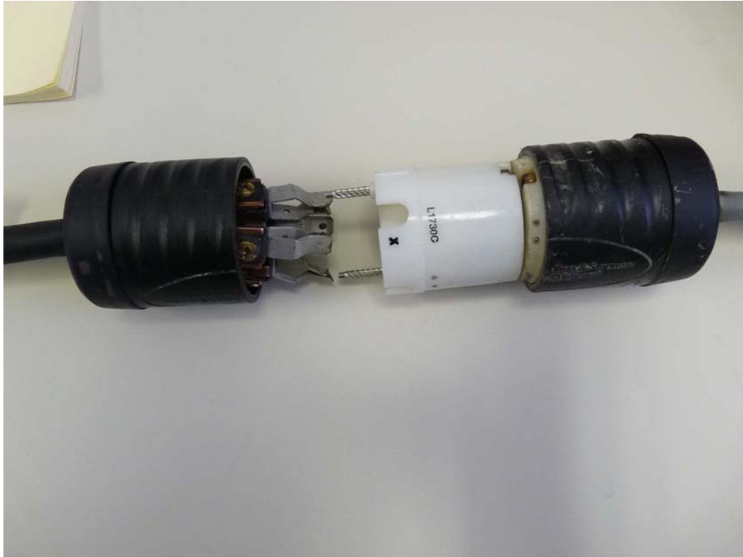
Photo 6 : Résultat de l'essai de traction sur le connecteur femelle.
