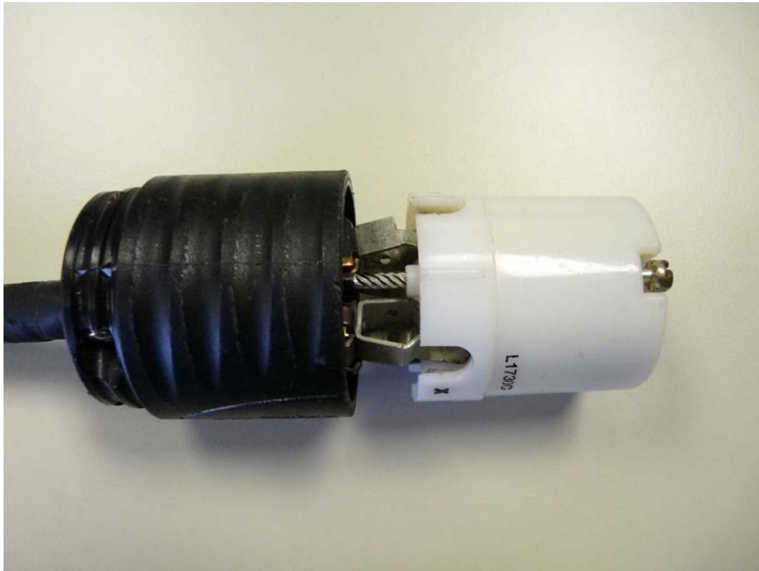
Photo 8 : État approximatif du connecteur femelle au moment de sa prise en charge par Monsieur «J».
