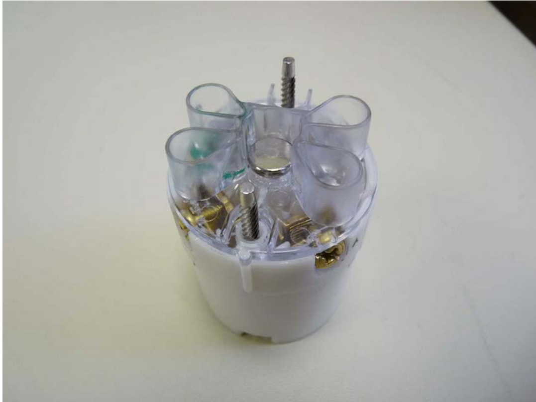
Photo 7 : Cheville métallique jumelant la plaque transparente à la section blanche d'un connecteur femelle neuf.
