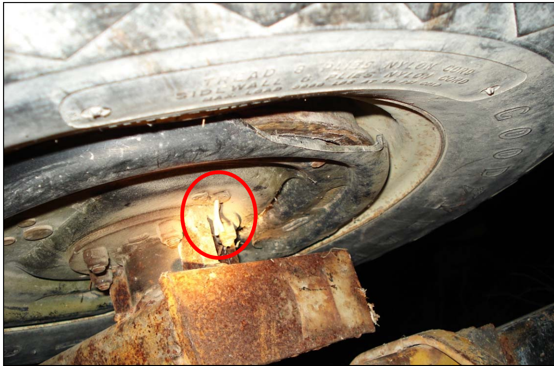
Photo 8 : Frein altéré de la chargeuse
