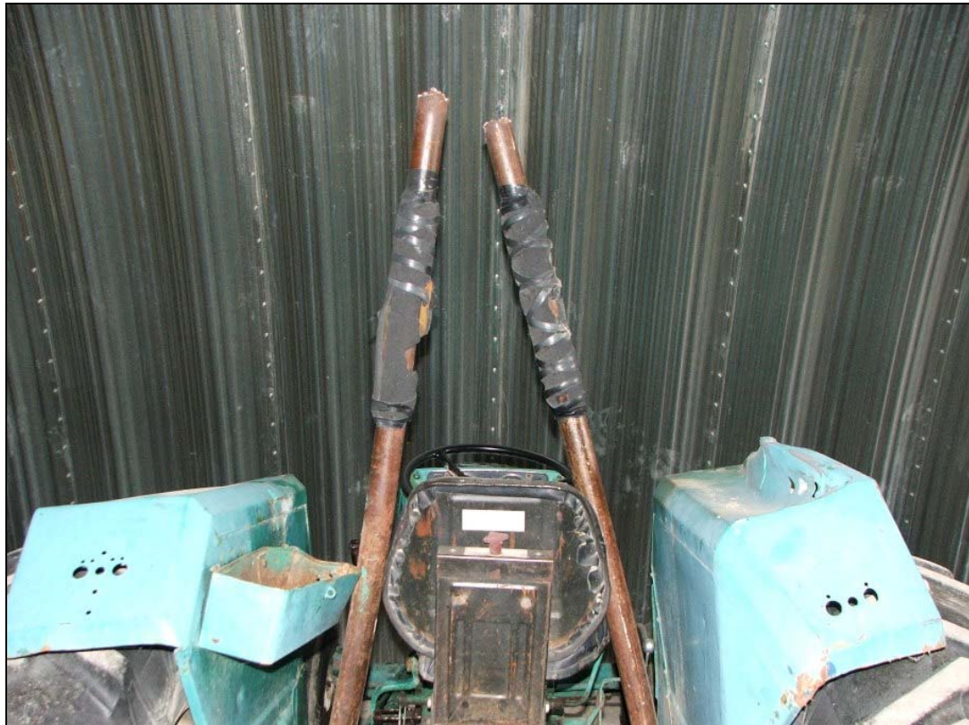
Photo 5 : Arceau brisé de fabrication maison
