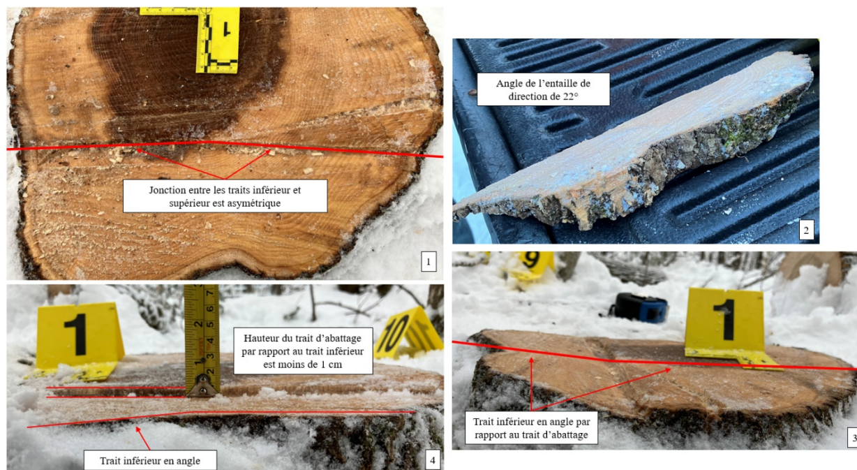
Fig. 15 - Entaille de direction et trait d'abattage
